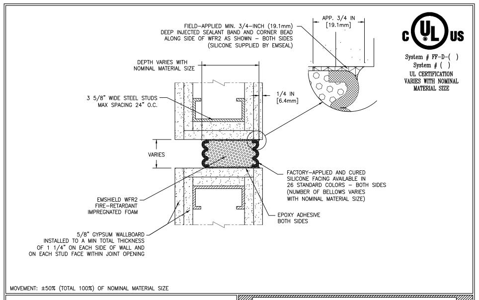
EMSHIELD WFR2 WALL TO WALL GYPSUM STEEL STUDS - TYPICAL
