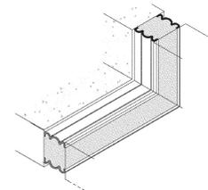
En plus de garantir l'étanchéité, les transitions EMSEAL fabriquées en usine permettent une installation grandement simplifiée et sécurisée, en éliminant les coupes et les raccords sur le chantier.
